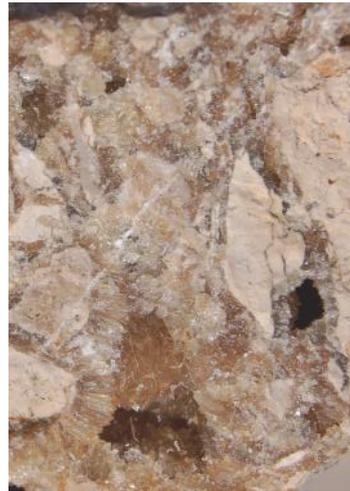
**Fig. 9. Dépôt de calcite dans un conduit.** L'eau circulante très riche en hydrogénocarbonate de calcium fournit la matière des cristaux de calcite (carbonate de calcium cristallisé) qui se forment dans les cavités et les conduits. Cavités et dépôts calcaires caractérisent un karst\* en profondeur.
