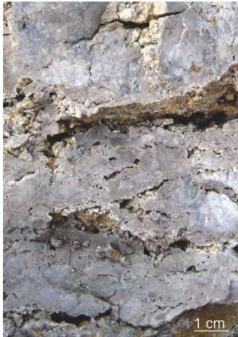
**Fig. 8. Calcaire karstifié.** Cavités et fissures sont nombreuses ; elles sont empruntées par l'eau météorique ou sont occupées en profondeur, par l'eau de la nappe phréatique. L'eau circulante dissout progressivement le calcaire (carbonate de calcium) qui devient hydrogénocarbonate de calcium dissous. Une telle eau est souvent improprement appelée eau « calcaire ».
