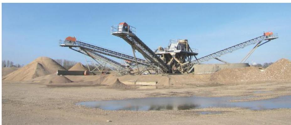
Fig. 3. Criblage (SMVL Suèvres, les Tailles). Les grains sont triés en plusieurs catégories selon leur taille.
