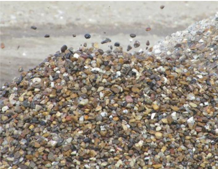
Les granulats alluvionnaires sont le matériau le mieux adapté pour la fabrication de bétons hautes performances (bétons haute résistance et bétons auto-plaçants). Par leur résistance, leur granularité et la forme arrondie des grains, ils sont moins déformables que la matrice de ciment du béton et empêchent la propagation de microfissures apparaissant au moment du retrait de la pâte. Leur fonction est donc fondamentale pour la résistance des bétons.
