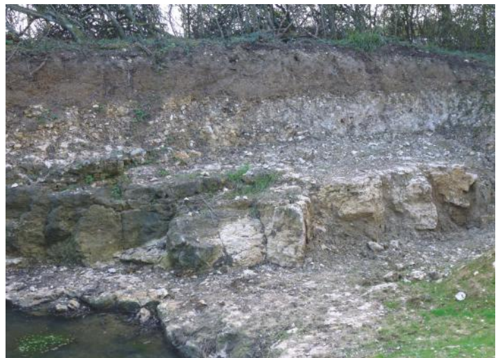
Fig. 1. Le front d'extraction. Les gradins d'extraction dans le Calcaire de Beauce, d'âge aquitarien, sont encore visibles. L'épaisseur exploitée est d'environ 2 à 3 mètres. L'extraction se poursuivait dans l'eau de la nappe phréatique du Calcaire de Beauce. Le niveau supérieur de la nappe suit étroitement les variations des précipitations.
